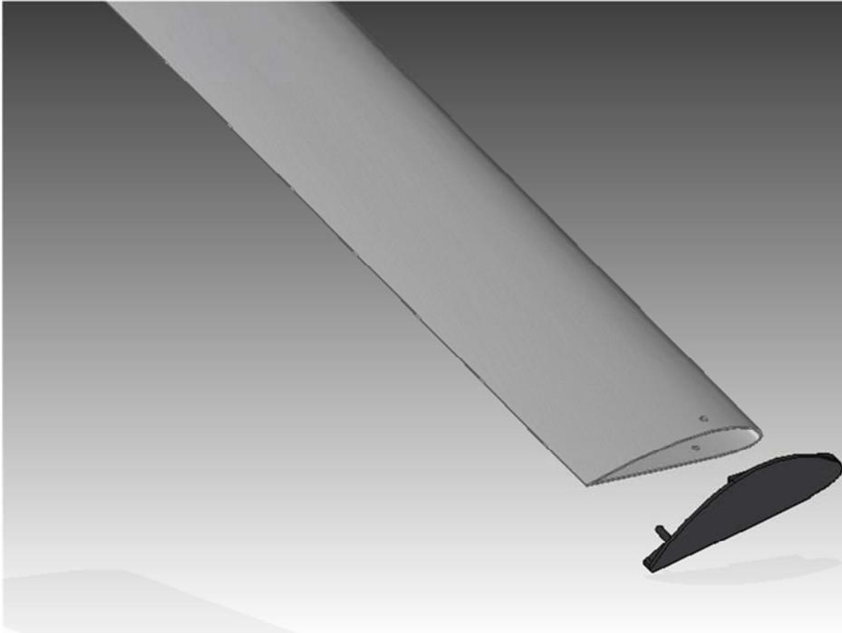
*POSITION THE WINGLET AT BLADE TIP
